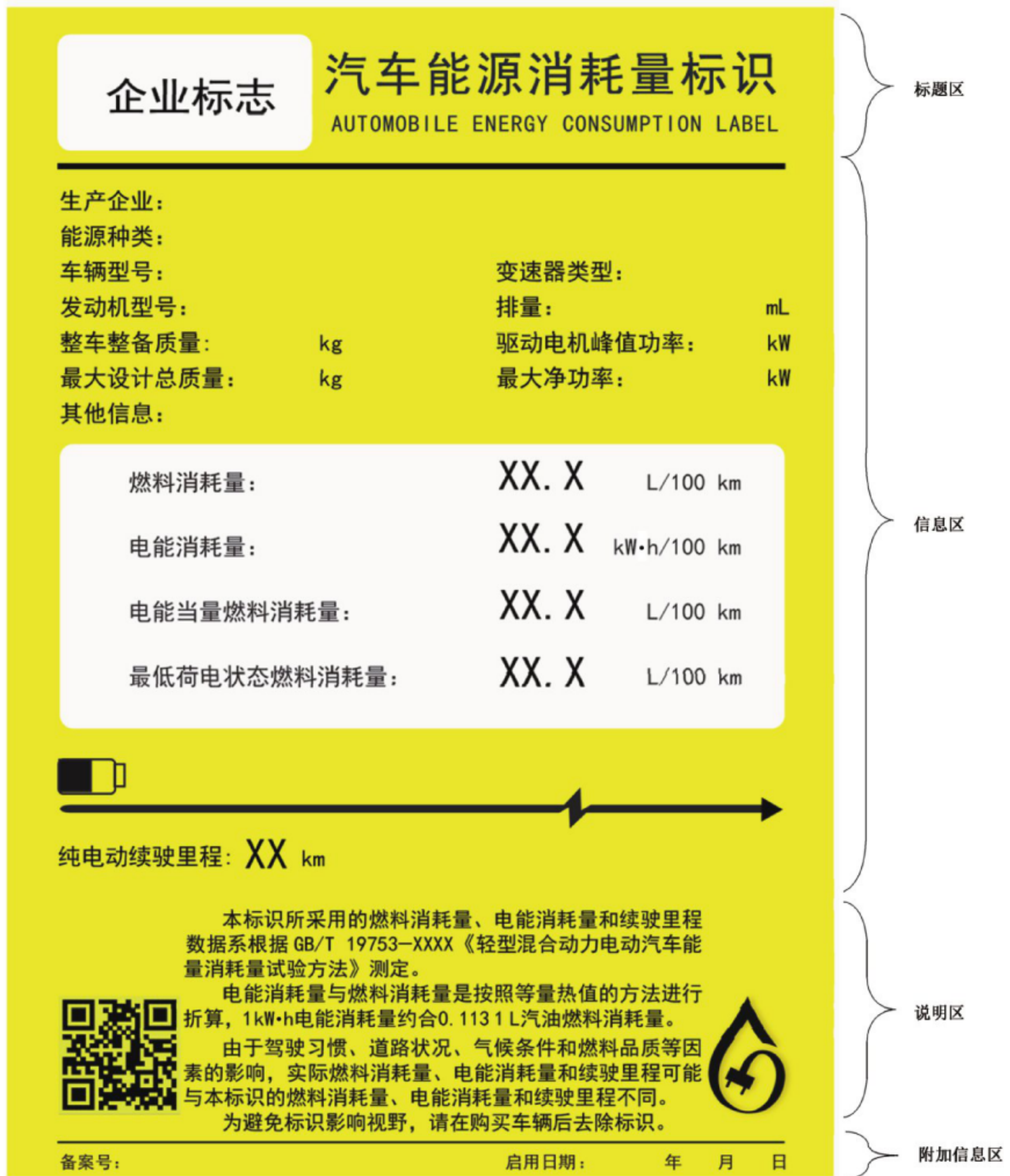
图 A.2 可外接充电式混合动力电动汽车标识各功能区分布示意图
