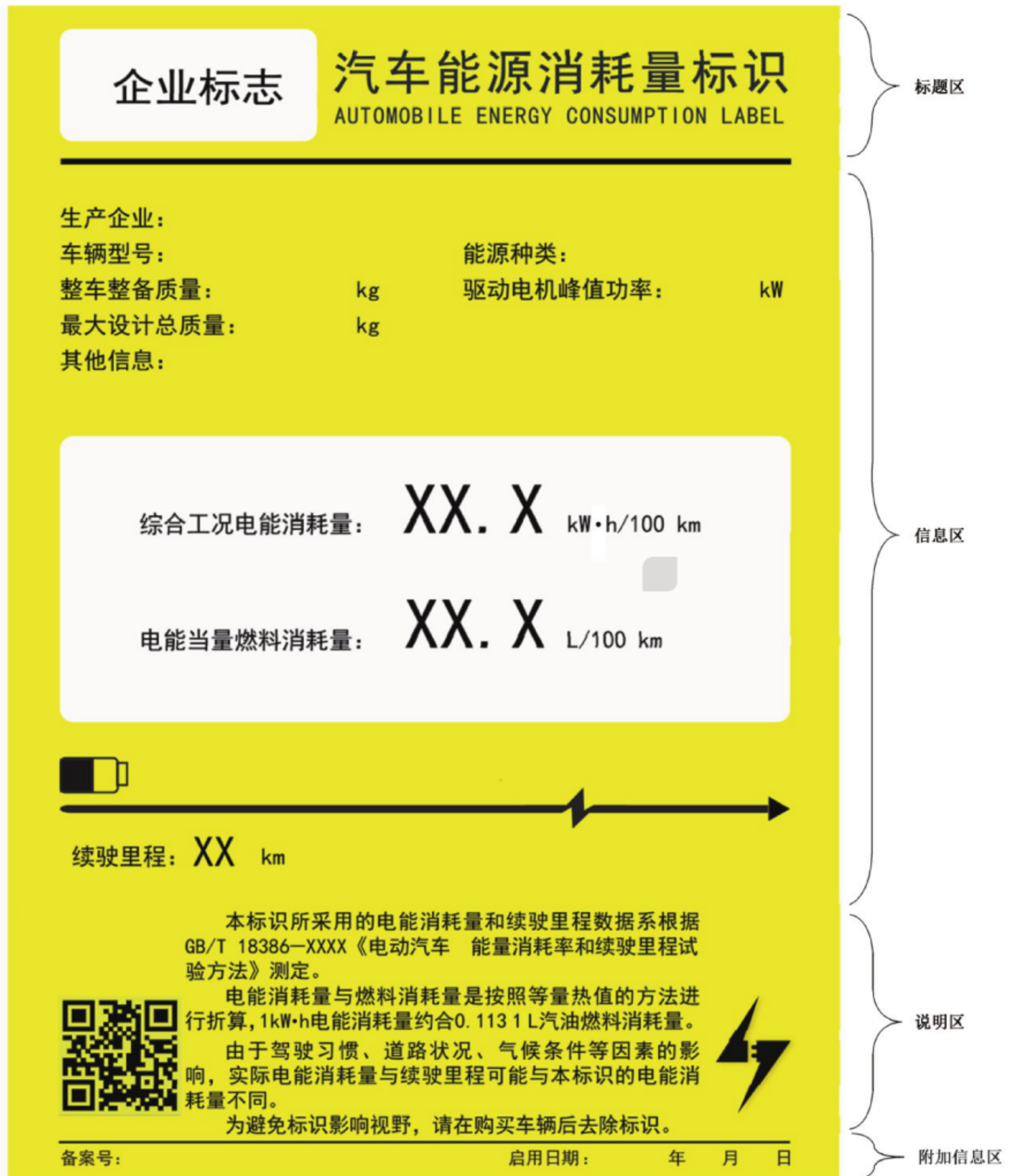
图 A.1 纯电动汽车标识各功能区分布示意图
